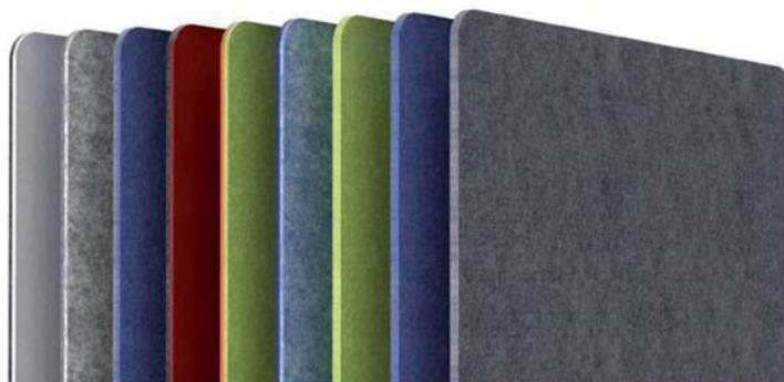
I pannelli fonoassorbenti AKUSTIX sono autoportanti, offrono una barriera visiva di gradevole impatto estetico ed un assorbimento dell'80% delle onde sonore udibili. Sono realizzati in PET al 100% riciclato e riciclabile. L'elevata densità garantisce una fonoassorbenza in classe B. Sono proposti come divisori mobili d'ambiente utilizzando i predisposti supporti oppure come schermi per scrivanie.
